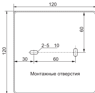
Рисунок 3. Установочные размеры проводного пульта
